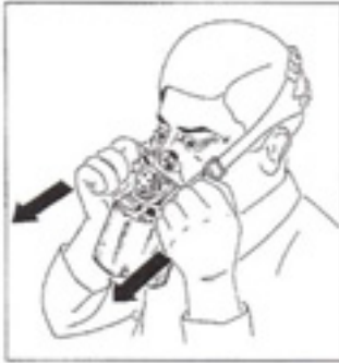
Fig. 6: Ponerse el atalaje para la cabeza y ajustarlo si es necesario.
